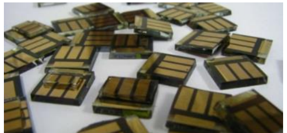
Na obr. sú solárne články vyrobené z perovskitov, Foto: University of Oxford
