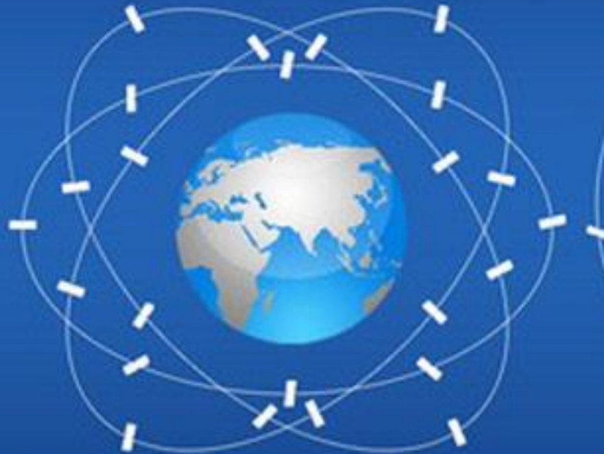
Подсистема космических аппаратов ГЛОНАСС 3 орбиты по 8 спутников
