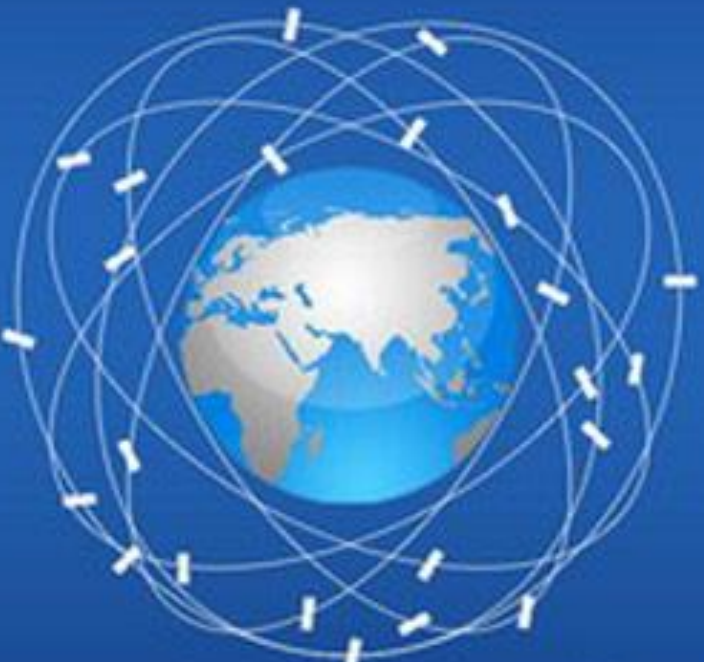
Подсистема космических аппаратов GPS 6 орбит по 4 спутника
