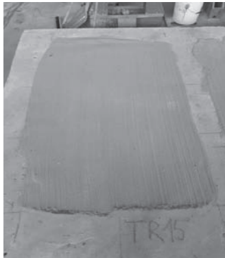
Obr. 3 – Aplikácia piesku na betónovú dosku skúšobnej vzorky č. 1
