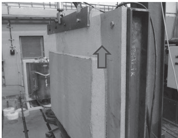
Obr. 1 Příprava zkoušky pro vypracování pracovního diagramu ETICS ve smyku. Je použita celá deska izolantu. Smyk je vnášen do vzorku tahem za výztužnou tkaninu základní vrstvy podle konceptu směrnice ETAG 004.
