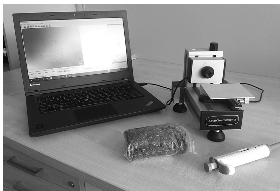
Obr. 1: Měření kontaktního úhlu na přístroji See System
