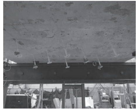
Obr. 7 – Porušenie kotviacich prvkov na vzorke č. 2 (bez lepiacej malty)
