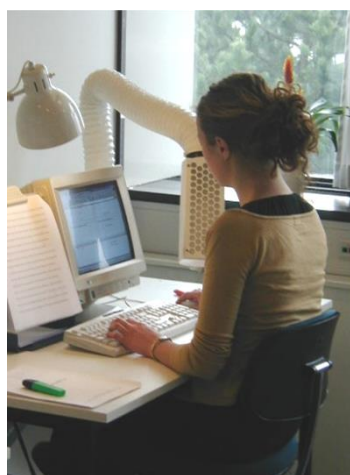
Obr. 2 Osobné vetranie. Fotografia z testovacích meraní na DTU, Dánsko.
