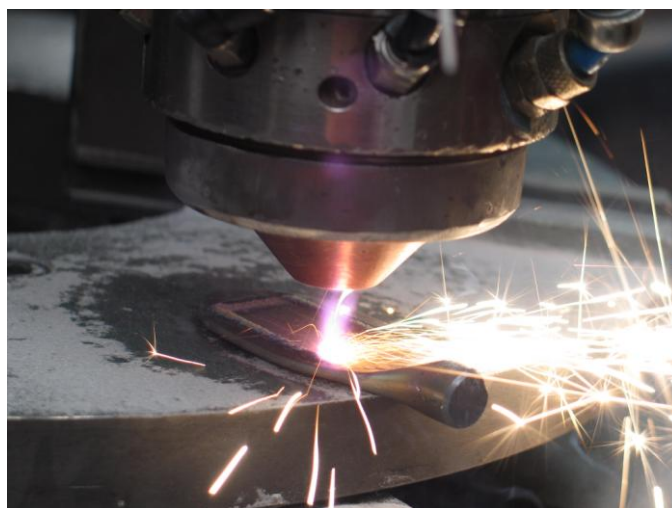
Obr. 5 Laserové navařování titanových vrstev
