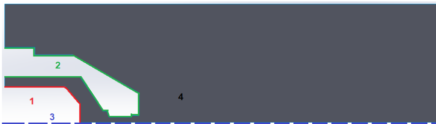
Obr. 2 2D model pre simuláciu: 1- elektróda zasunutá v dýze, 2 - stena dýzy, 3 - os symetrie, 4 - voľný priestor („solid body“) cez ktoré bude prúdiť médium
