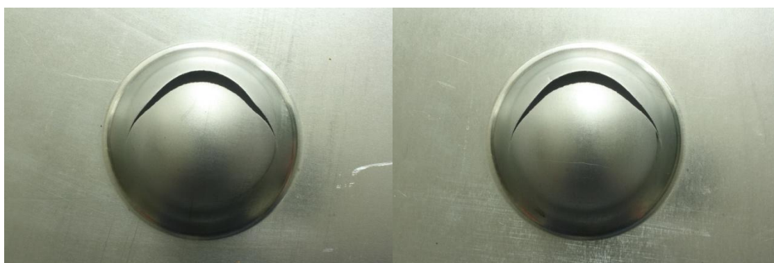
Obr.13 Vzhľad vtlačkov a trhlín na vzorkách z HX420 z vonkajšej strany
