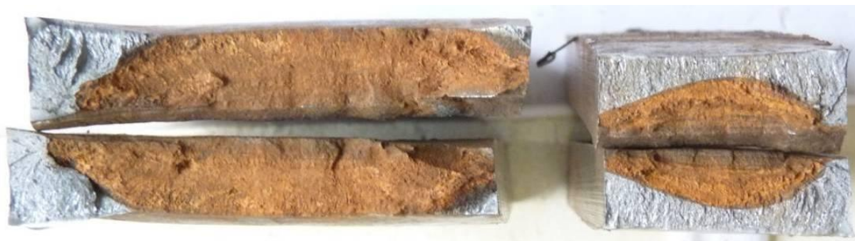
Obr.7.Lomové plochy po dolomení trhlín
