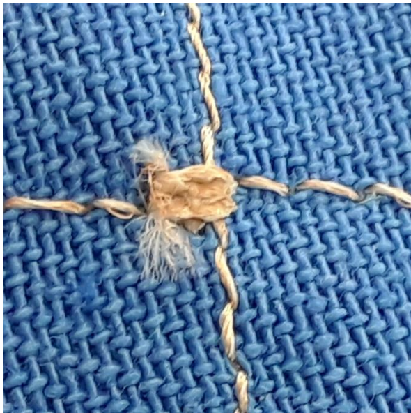
Obr.14. Zvar zhotovený tepelnou kompresiou TCB U elektródou [5]
