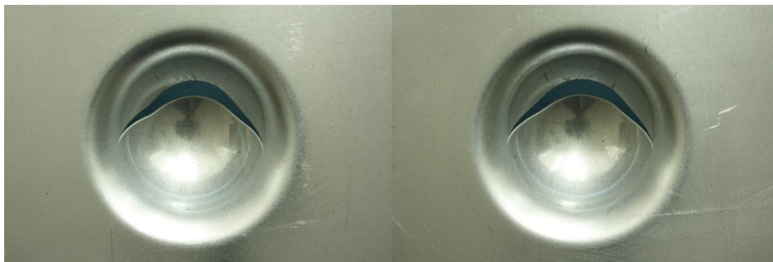
A 1 B 1 Obr.14 Vzhľad vtláčkov a trhlin na vzorkách z HX420 z vnútornej strany
