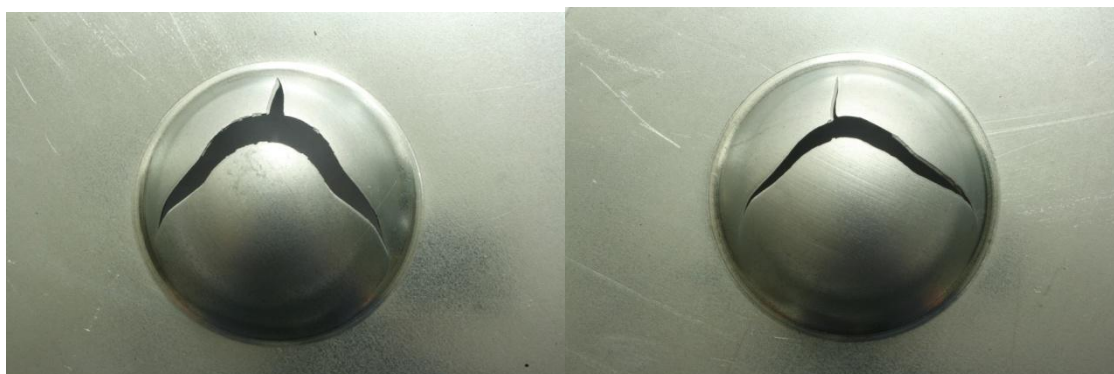
Obr.15 Vzhľad vtláčkov a trhlin z vonkajšej strany
