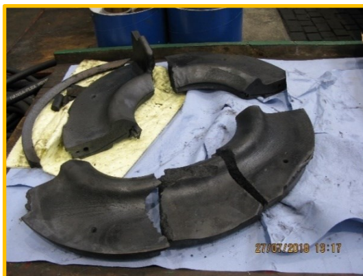
Obr. č. 4: Zaznamenané poškodenia na komponentoch kompresora
