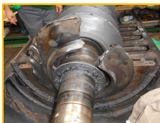
Obr. č. 4: Zaznamenané poškodenia na komponentoch kompresora
