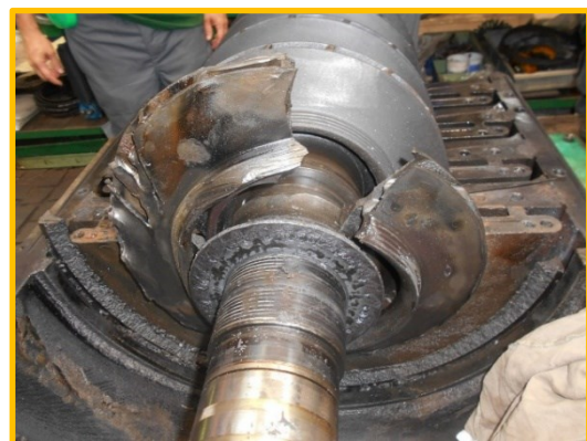
Obr. č. 4: Zaznamenané poškodenia na komponentoch kompresora
