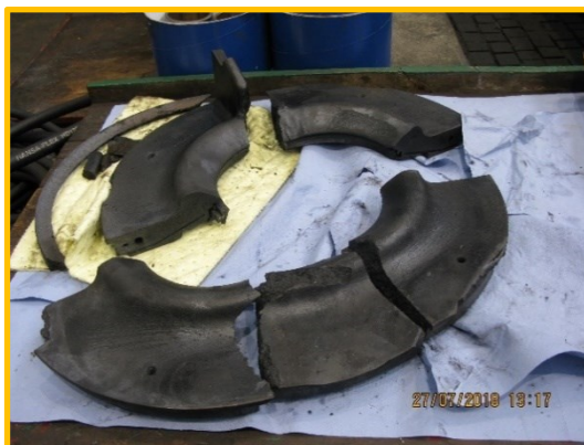
Obr. č. 4: Zaznamenané poškodenia na komponentoch kompresora
