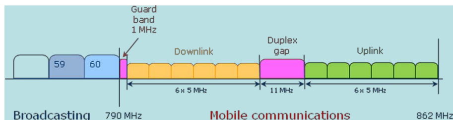
Obr. 1 – Frekvenčné pásma vyhradené pre vysielanie DVB-T/-T2 a LTE800
