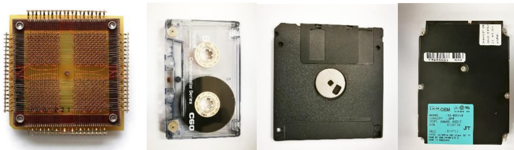
Vývoj magnetických pamätí: (Zľava- doprava) 1kB pamäť tvorená z feritových jadier (70. roky 20. stor.), magnetofónová páska (80. roky 20. stor.), 3,5" disketa, 1,44MB (90. roky 20. stor.), HDD (90. roky 20. stor.). (Zdroj: Wikipédia)
