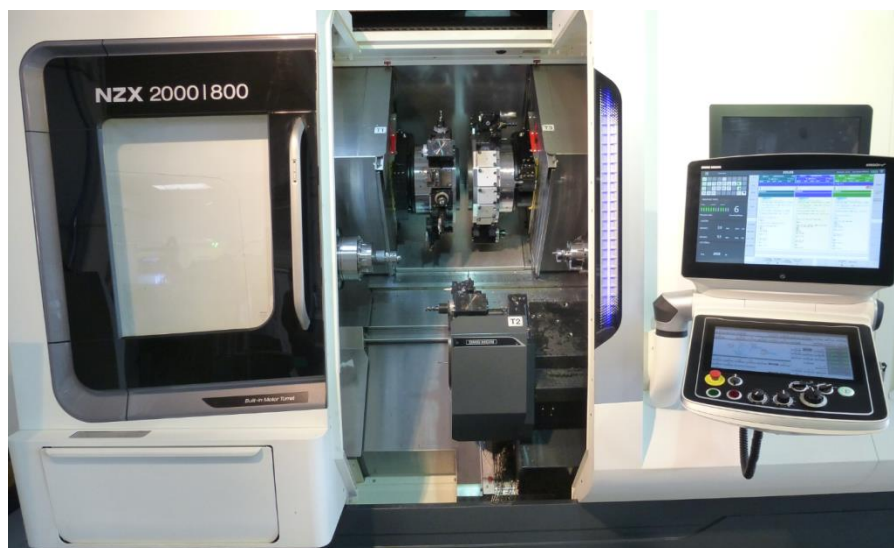
Obr.1 - CNC sústružníckej centrum NYX 2000/800 s nadstavbovým riadiacim systémom DMG Mori vybavené dvomi revolverovými hlavami a dvoma vretenami určené k progresívnym technológiám obrábania strojných súčiastok
