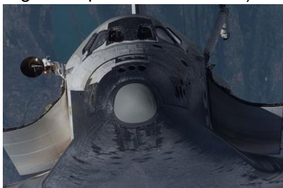
Obr. Plášť raketoplánu je tvorený keramickými dlaždicami
